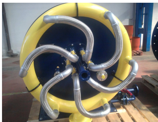
Obr. 4 Nízkoemisní výkonový hořák
