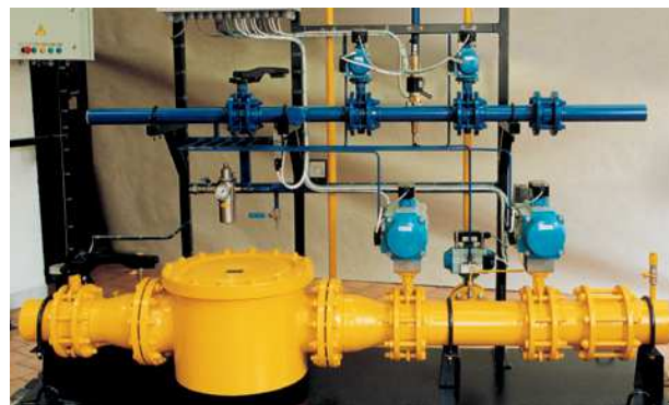
Obr. 5 Příslušenství hořáku – stojan armatur
